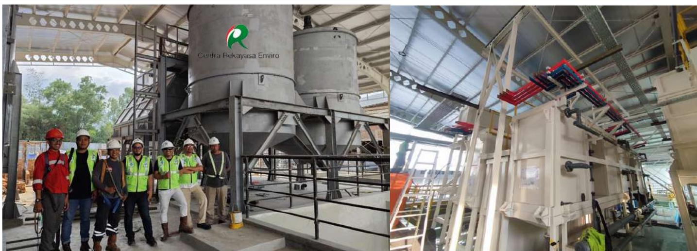
Untuk mengatasi tantangan ini, PT. CRE menerapkan teknologi elektrokoagulasi yang mampu menghilangkan kontaminan tersebut secara efektif. Proses ini menggunakan arus listrik untuk menggumpalkan partikel kecil dalam air, seperti logam berat, sehingga memudahkan proses pengendapan dan filtrasi. Proyek ini tidak hanya membantu mengolah limbah cair sesuai standar lingkungan yang ketat, tetapi juga mendukung efisiensi operasional pabrik.
