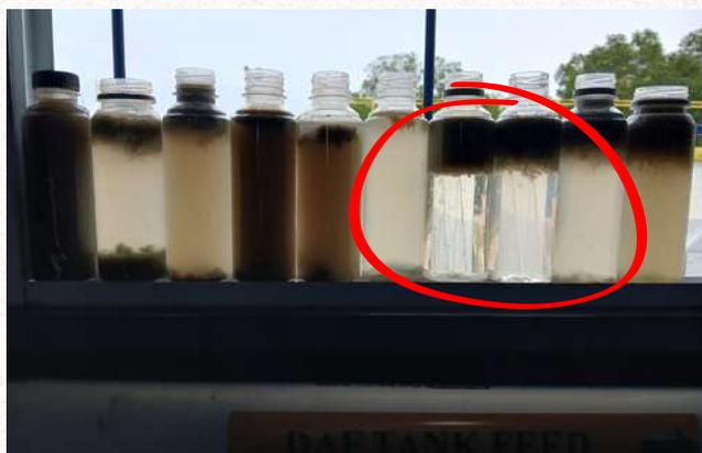
Gambar di atas menunjukkan hasil dari prototipe pengolahan air produksi yang sedang diuji dalam proyek ini. Prototipe ini mencakup beberapa tahapan penting dalam proses pengolahan, yang terlihat melalui hasil visual di berbagai botol yang menggambarkan perubahan kualitas air pada setiap tahap pengolahan. Dari air yang sangat keruh hingga air yang relatif jernih, proses ini menunjukkan efektivitas metode yang digunakan dalam mengurangi kandungan minyak dan padatan.
