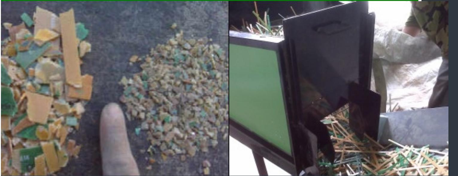
Crusher adalah equipment yang sering digunakan pada suatu sistem proses pengolahan. Istilah crusher atau pencacah lazim digunakan untuk mendeskripsikan proses reduksi ukuran dari material dengan tujuan tertentu. Proses pencacahan di gunakan sebelum atau sesudah dari sebuah system pengolahan.
