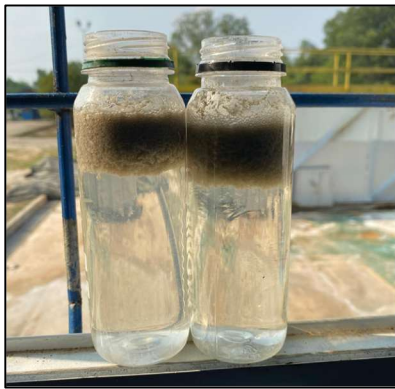
Pemisahan sludge dari limbah setelah reaksi elektrokoagulasi
