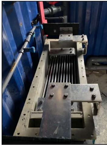
Reaktor Cubical Elektrokoagulasi
