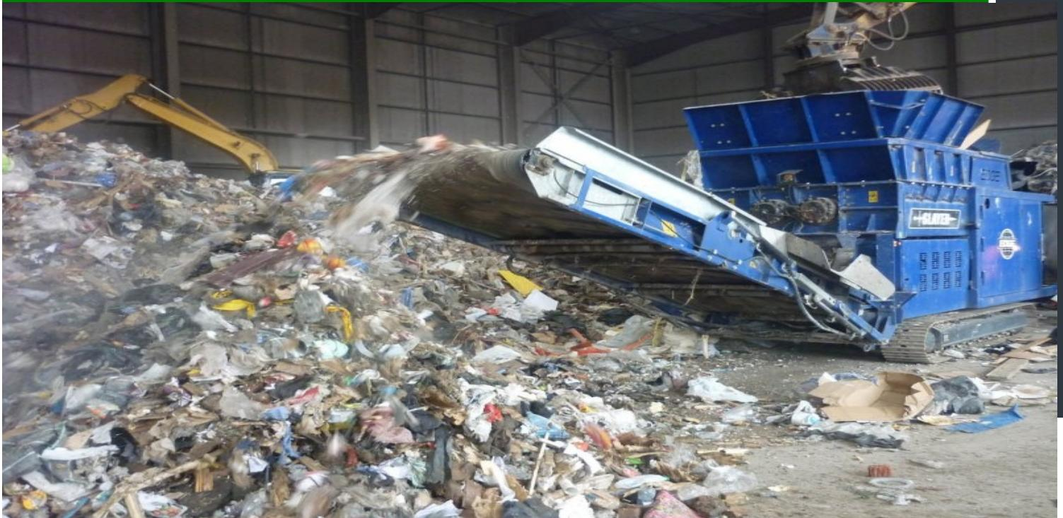
Shredder adalah sebuah alat pelengkap dalam sebuah alur proses, berfungsi untuk mereduksi ukuran (size) tertentu menjadi lebih kecil sesuai dengan diinginkan.
