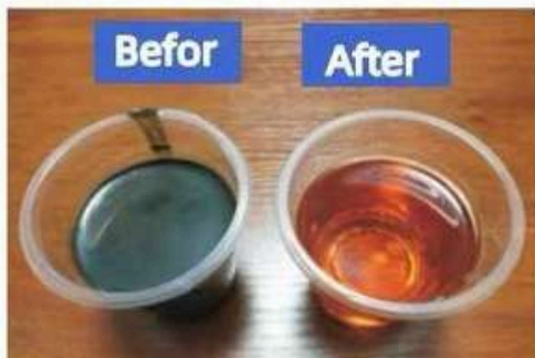
PERBANDINGAN FILTRASI OLI GEAR DENGAN JENIS ENDAPAN (SLAG)
